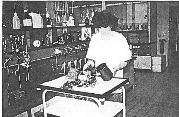
Eichenlaub wird zum Messen in eine speziell geformte Ringschale gepreßt, die über den Detektor gestülpt wird. Die Messung findet hinter einer sieben Zentimeter starken Bleiab-schirmung statt.
