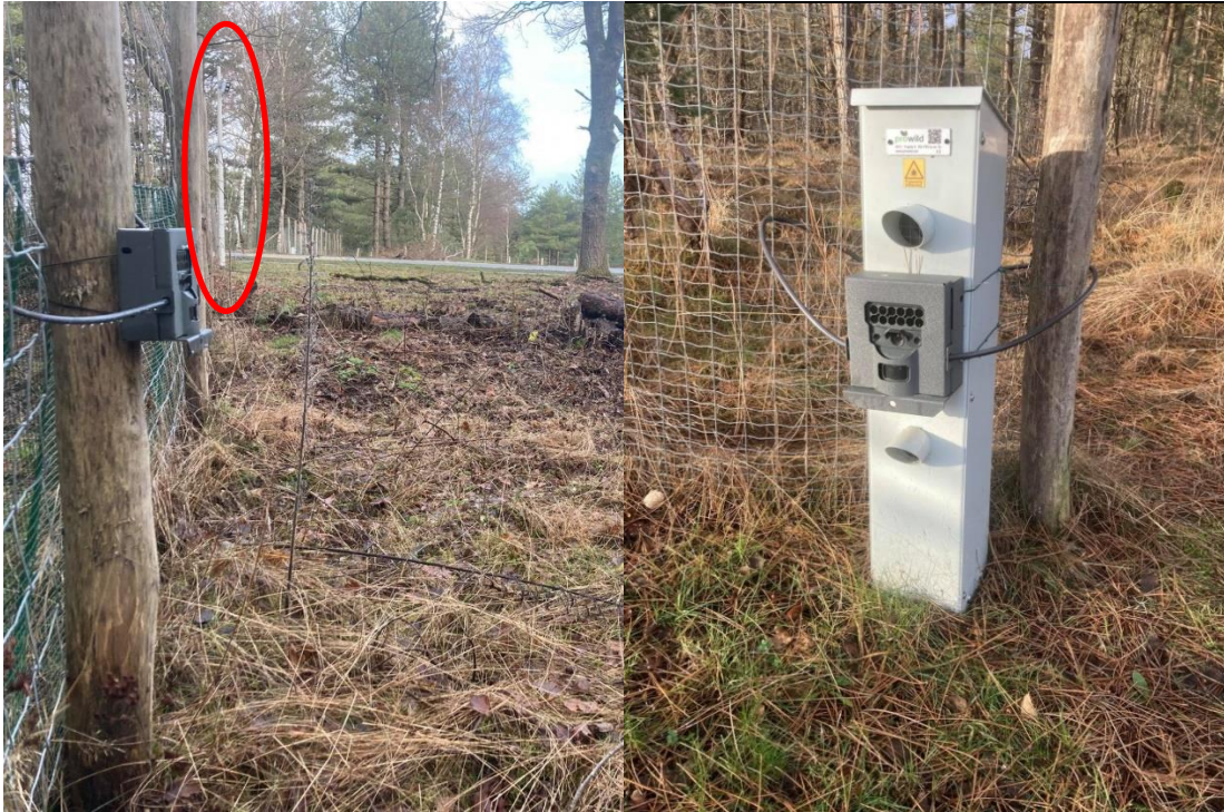
Foto 2: Opstelling van de cameravallen bij de vlakdetectiemast (links, mast in rode cirkel) en de lijndetectiepaal (rechts, cameraval tussen sensor op 30 cm en 60 cm, in sommige gevallen werd de cameraval ook naast de lijndetectiepaal bevestigd)
