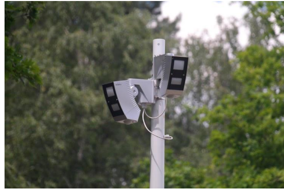
Foto 1: Foto van een lijndetectiepaal met een AIR sensor op 30 cm en 60 cm hoogte (links) en het vlakdetectiemast met 2 PIR sensoren (rechts) ©ProWild
