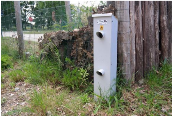
Foto 1: Foto van een lijndetectiepaal met een AIR sensor op 30 cm en 60 cm hoogte (links) en het vlakdetectiemast met 2 PIR sensoren (rechts) ©ProWild
