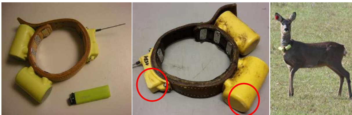
Abb. 11: GPS-Telemetriedhalsband der Firma e-obs GmbH für Rehe (li: unbenutzt mit Größenvergleich, Mitte: geringe Abschürfungen an Komponenten nach Verkehrsunfall, re: während Datenaufnahme).
