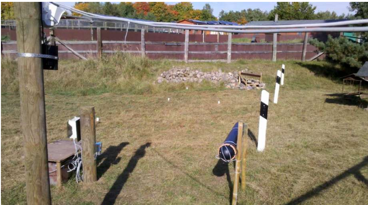
Abb. 48: Versuchsaufbau in Gehege RIII. Oben links am Bildrand ist die Infrarotkamera sowie der Infrarotscheinwerfer zu erkennen. Links unten die Lichtschranke mit entsprechender 12 V-Batterie in einer Box und rechts vorne die in einer Röhre eingebaute Lichtquelle. An den Straßenleitpfosten sind keine Wildwarnreflektoren montiert.
