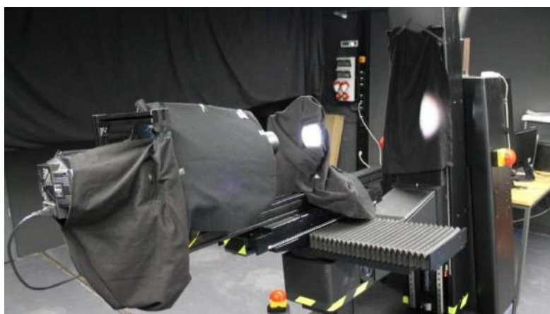
Abb. 56: Aufbau des Projektors auf dem Goniometer mit Abdeckung.
