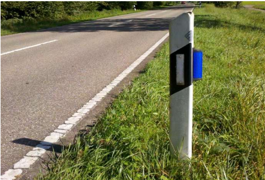
Abb. 12: Blauer Halbkreisreflektor der Firma Schilderwerk Beutha, der an allen Standorten in den beiden Untersuchungsgebieten zum Einsatz kam.
