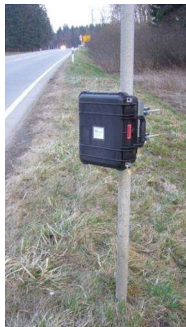
Abb. 8: Montiertes SDR-Gerät zur Erfassung des Verkehrsaufkommens am Standort Stetten.
