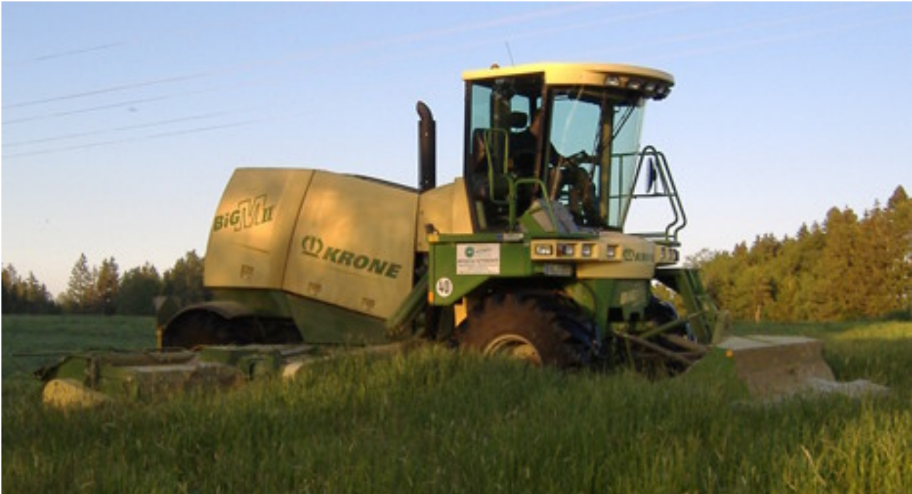
Hochleistungs-Mähaufbereiter - Mähbreite ca. 10 m - Stündliche Mähleistung ca. 15 ha (150.000 m 2 )
